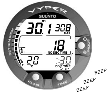
Abb. 3.32 Alarm, da die eingestellte Tauchzeit erreicht ist.
