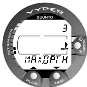
Abb. 4.29 Modus Einstellen des Tiefenalarms. [3 MAX DEPTH].
