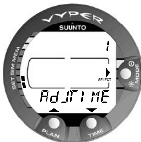
Abb. 4.34 Untermenü Einstellen der Uhrzeit. [1 Adj TIME].
