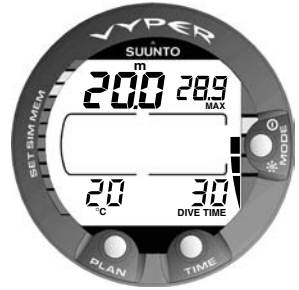
Abb. 3.26 Tauchen im Tiefenmesser-Modus (GAUGE-Modus).
