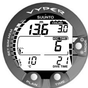
Abb. 3.17 Dekompressions-Tauchgang oberhalb der Deko-Grenze. Der nach oben gerichtete Pfeil ist verschwunden und ASC TIME blinkt nicht mehr; d.h. Sie befinden sich im Deko-Bereich.
