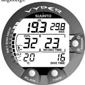
Abb. 3.25 OTU% erreicht die CNS%-Grenze. Das unterste Segment beginnt zu blinken.
