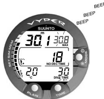
Abb. 3.33 Alarm, da die eingestellte maximale Tiefe erreicht ist.
