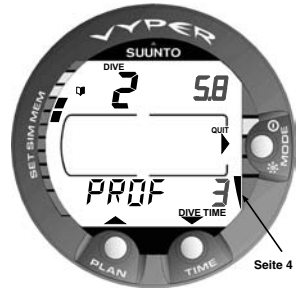
Abb. 4.10 Logbuch, Seite IV. Tauchgangsprofil.
