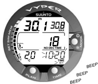
Abb. 3.31 Alarm, da die eingestellte Uhrzeit erreicht ist.
