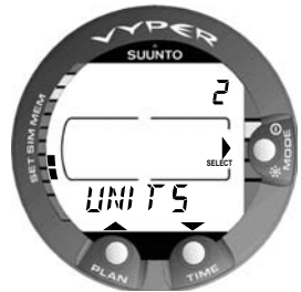
Abb. 4.43 Einstellen der metrischen bzw. imperialen Masseinheiten.
