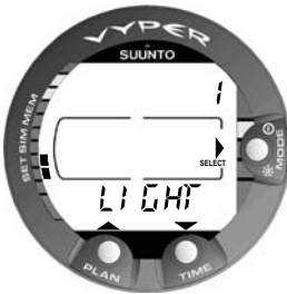
Abb. 4.41 Untermenü Zeit der Hintergrundbeleuchtung. [1 LIGHT].
