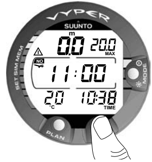
Abb. 3.29 Oberflächenintervall, Flugwarnung. Ein zweimaliges drücken des TIME-Kontaktes zeigt Ihnen die Zeit bis zum Ablauf der Flugwarnung, symbolisiert durch ein Flugzeug, an.
