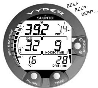
Abb. 3.23 Sauerstoff-Teildruck und OLF-Anzeige. Ein akustischer Alarm ertönt, weil der Sauerstoff-Teildruck grösser als 1,4 bar ist bzw. weil der eingestellte Wert und der Sauerstoffgrenzbereich (OLF) 80% erreicht hat.
