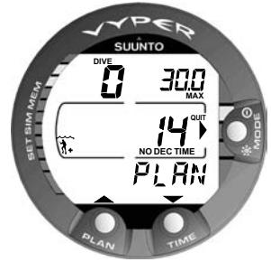
Abb. 3.6 Tauchgangsplanung. Der Text PLAN weist auf den Planungsmodus hin. Die Nullzeit in 30,0 m Tiefe beträgt 14 Minuten im Modus A0/P1.
