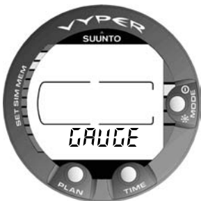
Abb. 3.3 Aktivierung III. Der Tiefenmesser-Modus.
