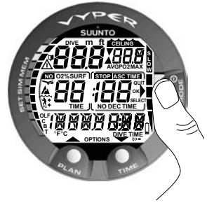
Abb. 3.1 Aktivierung I. Alle Segmente werden dargestellt.
