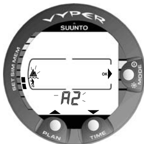
Abb. 4.25 Einstellung des Höhenmodus. Drücken Sie PLAN und TIME, um den Höhenmodus zu verändern.
