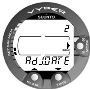
Abb. 4.36 Untermenü Einstellen des Datums. [2 Adj DATE].
