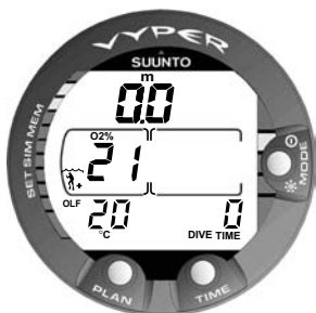
Abb. 3.21 Oberflächenanzeige im NITROX-Modus.
