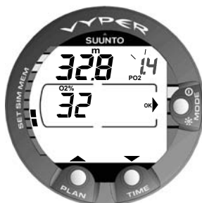
Abb. 4.32 Einstellen des Sauerstoff-Prozentsatzes und Teildruckes. Die zugehörige maximale Tiefe ist 32,8 m. Drücken Sie PLAN und TIME, um den Sauerstoff-Prozentsatz zu ändern und den Sauerstoff-Teildruck einzustellen.
