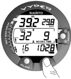
Abb. 3.24 Alternative Anzeige. Nach dem drücken des TIME-Kontaktes wird die aktuelle Uhrzeit, die maximale Tiefe und die restliche Nullzeit (CBT) angezeigt.
