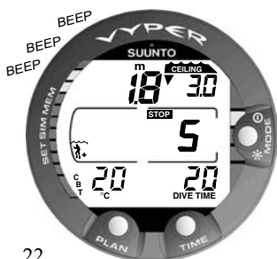
Abb. 3.15 Nicht eingehaltener vorgegebener Sicherheitsstop. Sie sollten wieder auf die vorgegebene Tiefe abtauchen.
