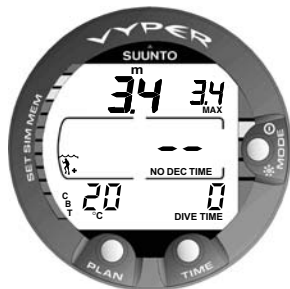
Abb. 3.7 Beginn des Tauchganges.
