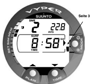
Abb. 4.9 Logbuch, Seite III. Die Oberflächenzeit und Durchschnittstiefe.
