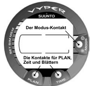
Abb. 2.2 Die Druckkontakte des Tauchcomputers.
