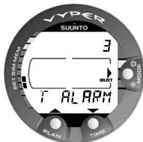
Abb. 4.38 Untermenü Einstellen des täglichen Alarms. [3 T ALARM].
