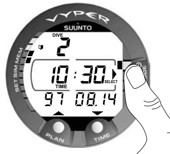
Abb. 4.11 Logbuch Seite I. Drücken Sie den MODE-Kontakt einmal, um zwischen den verschiedenen Tauchgängen zu blättern.
