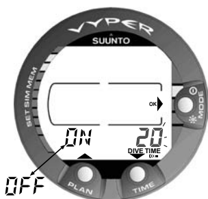
Abb. 4.28 Einstellen des Tauchzeitalarms. Drücken Sie PLAN und TIME, um den Alarm ein-/auszuschalten und die Tauchzeit einzustellen.
