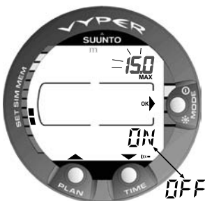
Abb. 4.30 Einstellen des Tiefenalarms. Drücken Sie PLAN und TIME, um den Alarm ein-/auszuschalten und die maximale Tiefe einzustellen.
