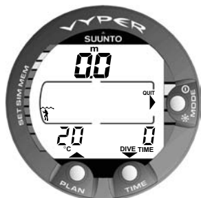
Abb. 4.18 Gewählter Modus Tauchsimation. Abtauchen durch drücken des TIME-Kontaktes. Auftauchen durch drücken des PLAN-Kontaktes.
