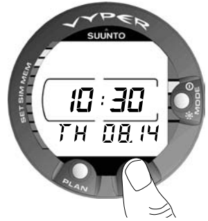
Abb. 2.1 Anzeige der Uhrzeit. Das Drücken des Kontaktes PLAN oder TIME aktiviert das Display.
