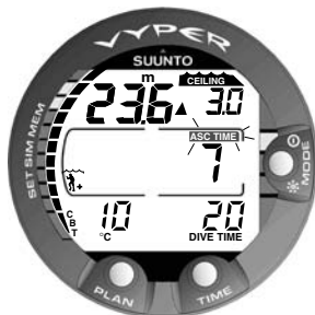
Abb. 3.16 Dekompressions-Tauchgang unterhalb der Deko-Grenze. Der Pfeil nach oben und die blinkende Anzeige ASC TIME weisen Sie darauf hin, aufzusteigen. Die minimale Aufstiegszeit, beinhalten den Sicherheits-stop, beträgt 7 Minuten. Die Deko-Stufe ist bei 3 m.
