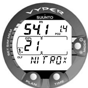
Abb. 3.20 Nitrox-Anzeige. Die maximale Tiefe basierend auf den Einstellungen O 2 % (21%) und PO 2 (1,4 bar) beträgt 54,1 m.
