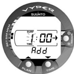
Abb. 4.20 Gewählter Modus Tauchgangsplanungssimulation. Fügen Sie eine Oberflächenpause ein, indem Sie die Kontakte TIME und PLAN drücken. Hinweis ! Diese Anzeige wird nur für Wiederholungstauchgänge darstellt.
