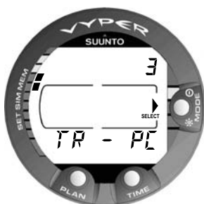
Abb. 4.15 Untermenü Datenübertragung. [3 TR-PC].
