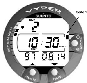
Abb. 4.7 Logbuch, Seite I, Hauptanzeige. Blättern Sie durch die verschiedenen Seiten des Tauchganges.
