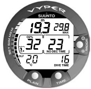
Abb. 3.22 Tauchen im NITROX-Modus. O_2\% ist auf 32% eingestellt.
