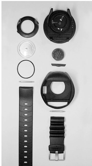
Abb. 5.1 Einzelteile des Tauchcomputers. Der Code hinter den Namen steht für die Bestellnummer des Einzelteiles.
