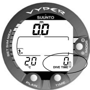
Abb. 3.5 Batteriewarnung. Das Batteriesymbol zeigt eine geringe Batteriespannung an. Die Batterie sollte ersetzt werden.
