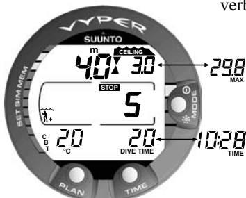
Abb. 3.14 Ein vorgegebener Sicherheitsstop.
