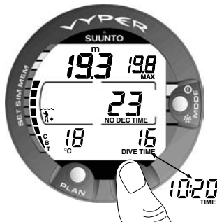
Abb. 3.8 Anzeige während des Tauchganges. Die aktuelle Tiefe ist 19,3 m und die Nullzeit beträgt im Modus A0/P1 23 Minuten. Die maximal bei diesem Tauchgang erreichte Tiefe war 19,8 m, bisherige Tauchzeit ist 16 Minuten und die Wassertemperatur beträgt 18 °C. Die aktuelle Uhrzeit 10:20 wird für 5 Sekunden nach dem drücken des TIME-Kontaktes angezeigt.
