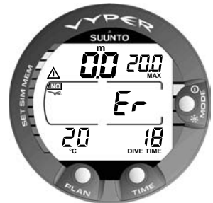
Abb. 3.30 Oberflächenmodus nach einem unterlassenen Deko-Tauchgang. Das Er-Symbol wird dargestellt, weil Sie eine Dekompressions-Stufe für mehr als 3 Minuten nicht eingehalten haben. Sie dürfen innerhalb der nächsten 48 Stunden nicht fliegen.
