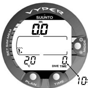
Abb. 3.4 Aktivierung IV. Der Oberflächenmodus: Tiefe und Tauchzeit sind Null (weil keine Tauchgänge bisher durchgeführt wurden). Die Temperatur beträgt 20 °C.
